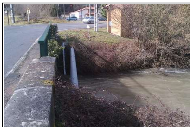
Figure III.6: Station limnigraphique sur le Ger à Aspet.
